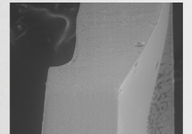
С – Профиль края оптики в области соединения гаптики и оптики, радиус кривизны < 10 мкр
